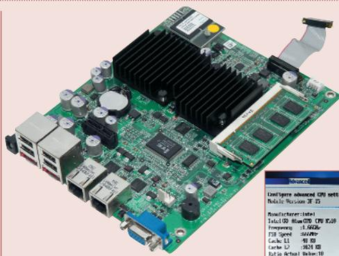
конденсаторы в этом NAS — твердотельные, что повышает его надежность и долговечность.
